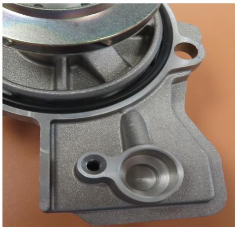
La pompe à eau OE a un emplacement pour l'actuateur électrique avec deux trous à l'intérieur. Ceux-ci permettent, en exploitant la pression du liquide, de faire baisser la bague métallique. La pompe à eau Sasic est une pompe traditionnelle (non actionnable) sans bague métallique, ni trous, par conséquent l'emplacement de l'actuateur n'est pas usiné. La pompe à eau Sasic est interchangeable et son installation ne cause aucune anomalie au moteur et/ou au tableau de bord
